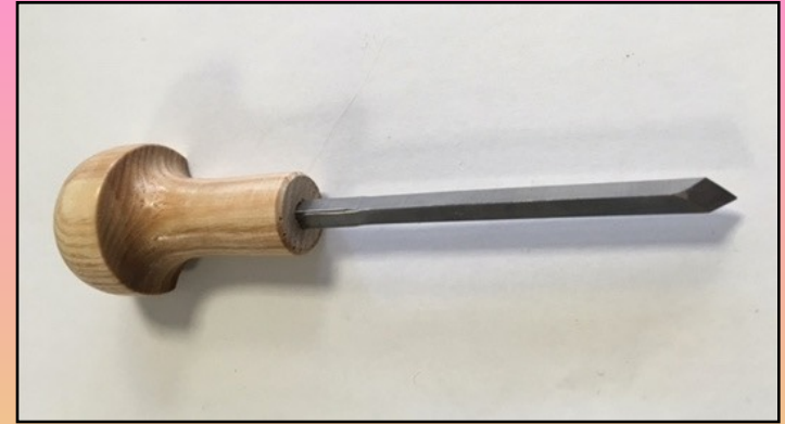
Foto in alto: lo strumento del bulino. Foto in basso: particolare ingrandito di una incisione a bulino.
